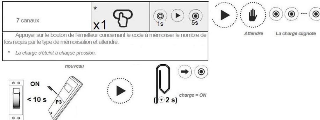
Dans les 10 s qui suivent la mise sous tension appuyer sur le bouton P3 de l'émetteur et le maintenir appuyé 2 s. Relacher P3 et appuyer sur un bouton de la télécommande pendant 5 s les leds vont s'allumer puis clignoter et s'éteindre et vous relâchez le bouton.
