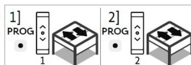
2] Appuyer brièvement sur le bouton **PROG** au dos du second point de commande io jusqu'au va-et-vient du produit motorisé sur la sortie concernée.
