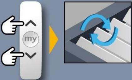
Faire un appui simultané et long (5s) sur Montée et Descente jusqu'au va et vient du vérin
