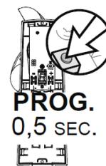
**3- Ajustement du seuil de sensibilité au vent :** (il y a 9 seuils qui graduent la sensibilité à la vitesse du vent de 10 à 65 km/h)
